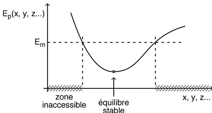
Dans le cas d'un puits d'énergie potentielle, le point oscille entre des positions extrêmes (oscillations amorties s'il y a en plus des frottements).
