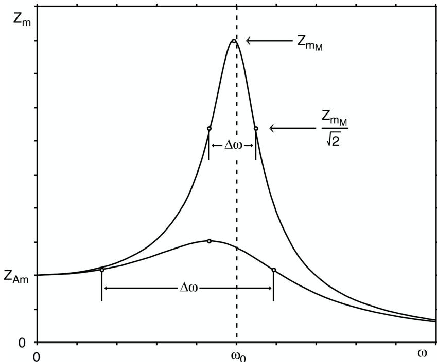
On obtient ainsi :  $\omega^4 - 2\omega^2\omega_r^2 + 2\omega_r^4 - \omega_0^4 = 0$  et  $\omega^2 = \omega_r^2 \pm \sqrt{\omega_0^4 - \omega_r^4}$ .
