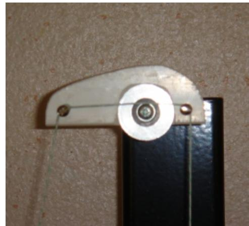
Pour compenser, nous avons bricolé des réducteurs d'amplitude qu'on peut aisément placer au niveau de la poulie (simples bras de levier qui divisent l'amplitude par deux ou trois). Il est nécessaire (et suffisant) de faire un tour de fil autour de chacune des deux vis pour éviter le glissement. Les résultats ainsi obtenus sont tout à fait concluants.
