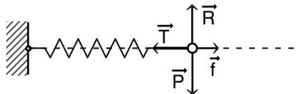
La réaction normale  $\vec{R}$  du support compense le poids  $\vec{P}$  (mouvement horizontal) ; par ailleurs, tant qu'il y a glissement, le frottement  $f = \lambda R$  (selon la direction et le sens contraire du mouvement) est constant (dans ce cas).
