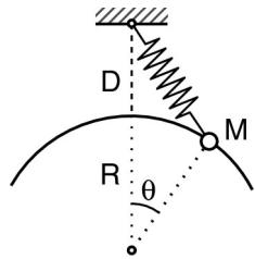
2. • Dans le dispositif ci-contre, le mobile  $M$  a une masse  $m$ , le ressort a une raideur  $k$  et une longueur "à vide"  $L_0 = D$  (il reste tendu).
