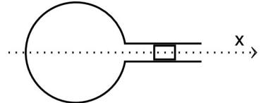
• En admettant que le gaz dans le récipient évolue de façon adiabatique (sans transfert de chaleur), on peut montrer (en thermodynamique) que la pression évolue selon la loi :  $p V^\gamma = p_0 V_0^\gamma$  où  $\gamma$  est un coefficient caractéristique des propriétés du gaz :  $\gamma = 1,4$  pour l'air. En déduire la période des petites oscillations.
