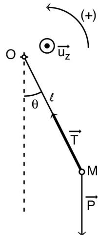
◊ remarque : si le pendule est lâché immobile, le mouvement débute dans le plan vertical contenant  $O$  et  $M$  (les forces sont dans ce plan) ; mais si le mouvement est dans un plan vertical contenant  $O$ , alors  $\vec{L}_O \parallel \sum \vec{M}_O = \dot{\vec{L}}_O$  donc le mouvement reste dans ce plan (perpendiculaire à  $\vec{L}_O$ ).
