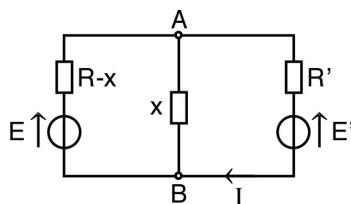
3. • La loi de Millmann donne ainsi (s'il y a électrolyse) :  $U_{AB} = \frac{\frac{E}{R-x} + \frac{E'}{R'}}{\frac{1}{R-x} + \frac{1}{x} + \frac{1}{R'}} = \frac{R'E + (R-x)E'}{R'R' + (R-x)x}x$ .
