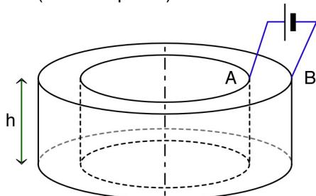
D'après les symétries, on peut raisonnablement supposer que la densité de courant est radiale et ne dépend que de  $r$  : uniformément répartie par rapport à l'angle  $\theta$  et l'altitude  $z$  (ce qui est plausible pour un conducteur homogène). Ceci correspond, compte tenu de la loi d'Ohm locale, à un champ  $\vec{E}$  radial dont la coordonnée radiale  $E_r$  ne dépend que de  $r$ .
