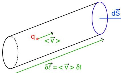
En intégrant sur une surface  $S$ , la charge  $\delta Q$  qui traverse pendant un intervalle  $\delta t$  est donc :  $\delta Q = \iint_S dQ = \iint \vec{j} \cdot d\vec{S} \delta t$ .
