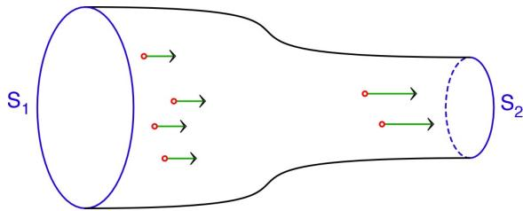
En particulier, pour un fil conducteur de diamètre variable, la densité de courant en régime permanent doit donc être plus grande dans les zones où le diamètre est plus petit. Ainsi, dans la mesure où la densité volumique des porteurs de charge est uniforme, il y en a plus dans la section plus grande donc ils se déplacent en moyenne moins vite.
