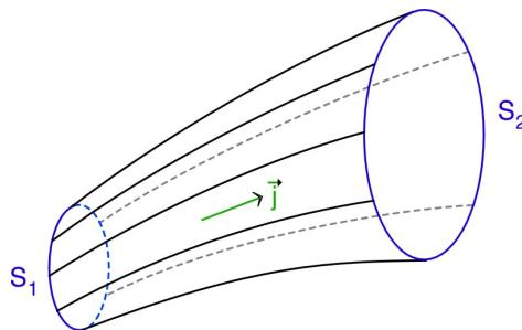
◊ remarque : les équations cartésiennes des lignes de courant peuvent être obtenues en intégrant les équations différentielles :  $\frac{dx}{j_x} = \frac{dy}{j_y} = \frac{dz}{j_z}$  (d'après le parallélisme entre  $\vec{j}$  et un déplacement  $d\overrightarrow{OM}$  le long d'une telle ligne).
