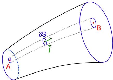
Par suite :  $U_{AB} = \delta I \int_A^B \frac{d\ell}{\gamma \delta S}$ , c'est-à-dire que le courant dans le “tube” est proportionnel à la tension  $U_{AB}$  :  $\delta I = \delta G U_{AB}$  avec un coefficient de proportionnalité :  $\delta G = \frac{1}{\int_A^B \frac{d\ell}{\gamma \delta S}}$ .
