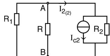
$$\text{Le courant total cherché est donc : } I_2 = I_{2(1)} + I_{2(2)} = \frac{R E_1 + (R + R_1) R_2 I_{c2}}{R_1 R_2 + (R_1 + R_2) R}.$$
