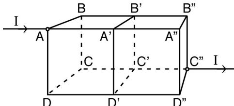
1. • Ce double-cube est relié à un circuit extérieur par deux sommets opposés  $A$  et  $C''$ . Montrer que ce réseau est symétrique par rapport au plan  $AA''C''C$ .
