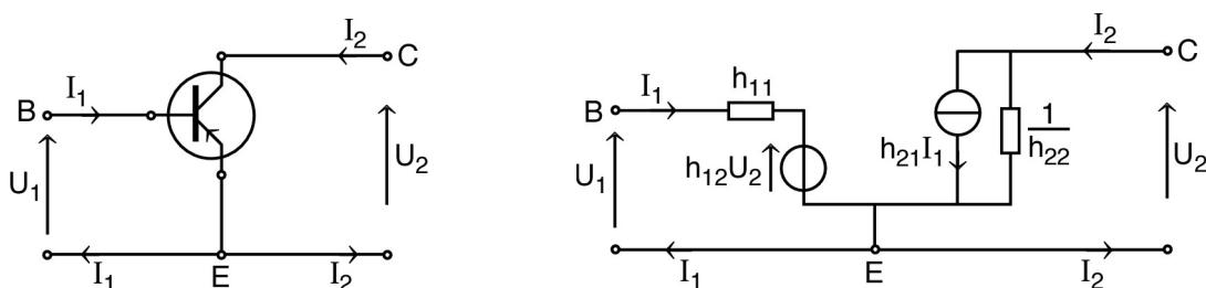
◊ remarque : la conservation de l'énergie nécessite, en plus de la source de tension qui fournit  $U_1$ , une alimentation dans le circuit de sortie (non représentée ici).
