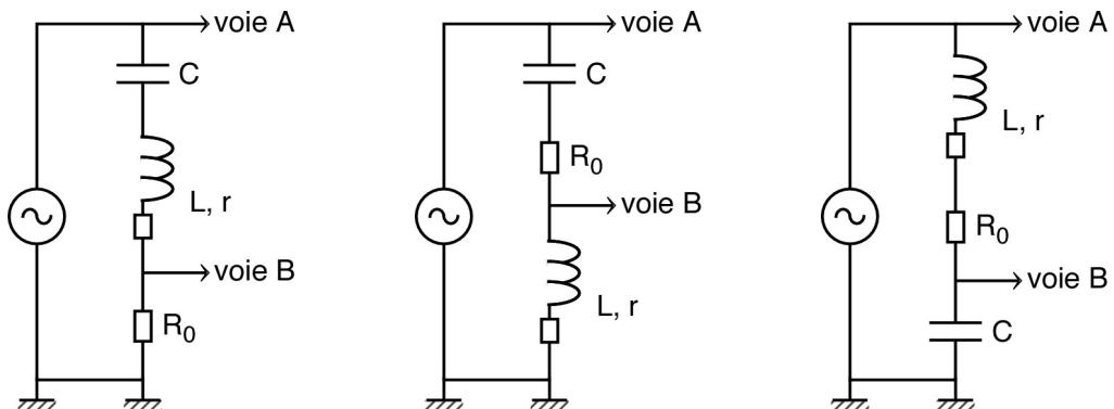
☞ rappel : vérifier (entre autres) que tous les calibres de l'oscilloscope sont bien en position "calibrée" (sinon les valeurs lues ne correspondent pas à l'étalonnage inscrit sur le calibre !) et que les interrupteurs des deux voies sont bien en position "DC" (sinon les signaux peuvent être déformés).
