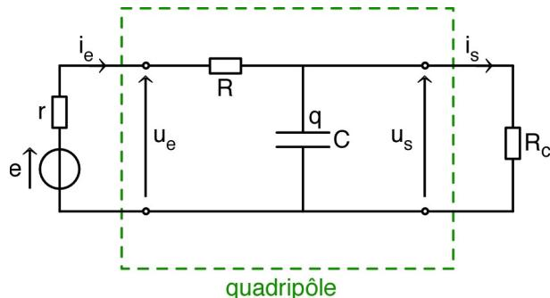
1. • Déterminer le gain (complexe) en tension  $\underline{H}_u = \frac{\underline{u}_s}{\underline{u}_e}$  .
