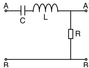
2. • Exprimer  $\underline{H}$  en fonction de  $x = \frac{\omega}{\omega_0}$  (avec  $\omega_0$  pulsation à la résonance) et du facteur de qualité  $Q$  . Tracer les diagrammes de Bode de  $H(\omega) = |H(\omega)|$  et  $\phi(\omega) = \arg(H(\omega))$  .
