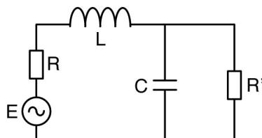
2. a) Dans les cas où  $R' < R$ , on réalise le montage ci-après ; déterminer les valeurs de  $L$  et  $C$  qui rendent maximum la puissance transférée.
