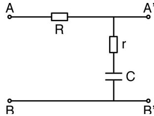
2. • Exprimer  $\underline{H}$  en fonction de  $\omega$ ,  $\omega_0 = \frac{1}{rC}$  et  $\alpha = \frac{r}{r+R}$ .
