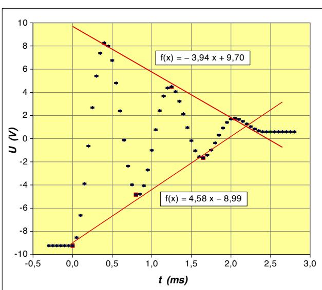
• Courbe ci-dessus: la valeur limite  $U_{\text{lim}}$  ne correspond pas à l'intersection  $U_{\text{ext}}$  des droites passant respectivement par les maximums et par les minimums (c'est caractéristique du frottement solide).
