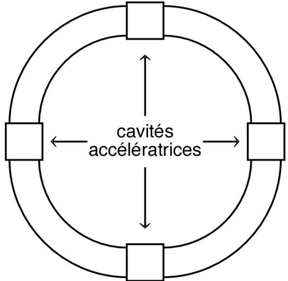
◊ remarque : la relation  $p = qBR$  permet aussi de mesurer la quantité de mouvement en mesurant le rayon de courbure.
